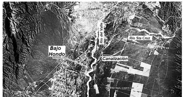
Figura 13. Canalización del río Santa Cruz. Tramo sur, año 1994
