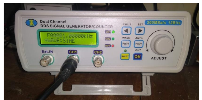
Figura 15. Generador de funciones con señal senoidal de 1KHz
