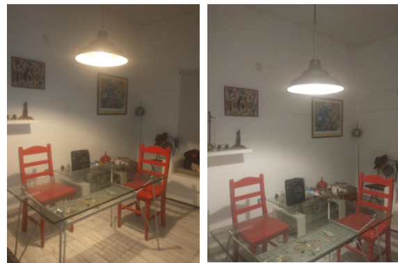
Figura 7: Campana grande con lámpara de 14W cálida (izquierda), y 14W fría (derecha)
