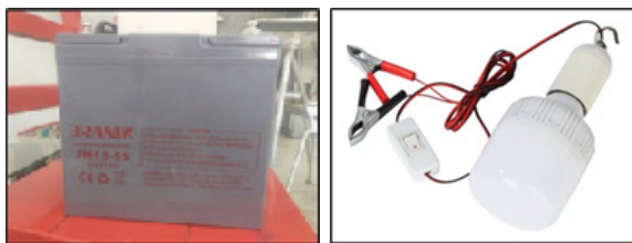
Figura 8: Batería tecnología AGM-GEL sellada e y lámpara 12V 18W DC empleados en el ensayo
